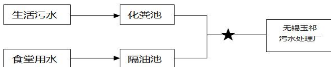
图 3-1-1 废水监测点位 ★ 代表废水监测点位
