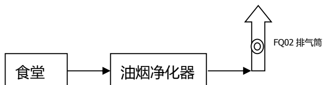
图 3-1-2 有组织废气处理工艺 ◎ 代表有组织废气监测点位
